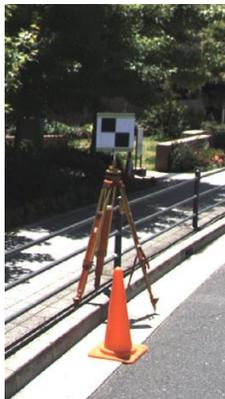
現場に設置した調整点の例
