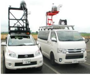
レーザー・カメラの高所設置
