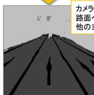
カメラ画像を路面・路面ペイント・その他の3クラスに分類
