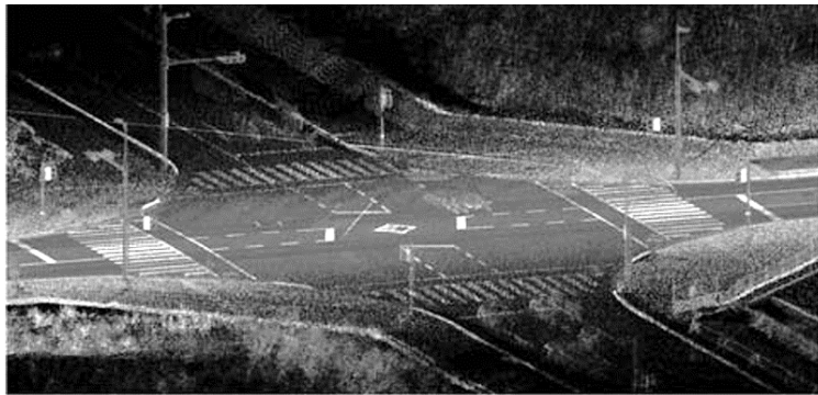
MMSで観測した三次元点群データ
